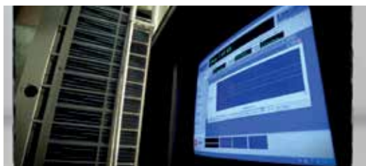
Le transport est simulé et les vibrations sont testées sur notre agitateur (recherche : vibration ZEAS)
