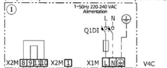
Deposier les 2 points de fils, positions 8-10 et 9-11, au niveau de la borne X1M. Se reporter à la page 6 pour en savoir plus sur l'installation du contact d'alimentation électrique à taux de kWh avantageux. (Voir manuel d'installation)
