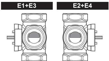
4 Lors de l'installation conformément à la configuration E3 ou E4, ouvrez le couvercle du moteur de vanne en desserrant la vis et changez le fil de liaison de manière à modifier le sens de rotation de la vanne.
