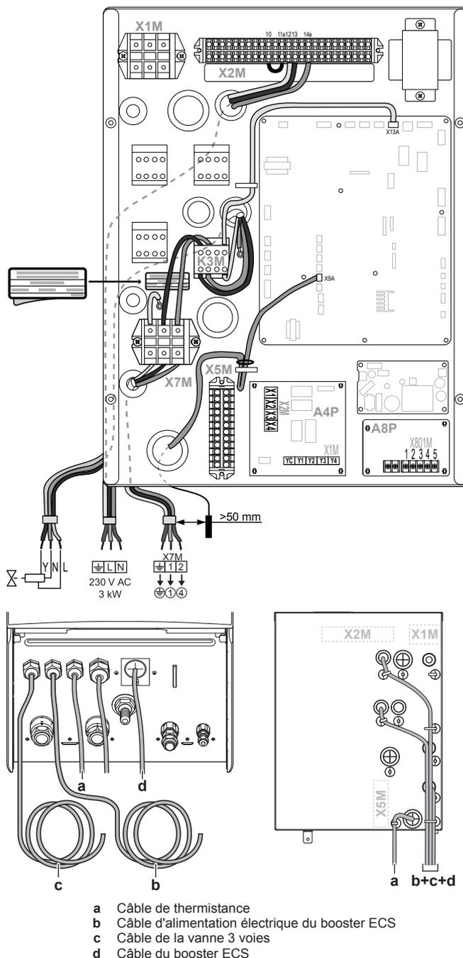
**6.5.3 Raccordement du câblage électrique sur l'unité extérieure**
