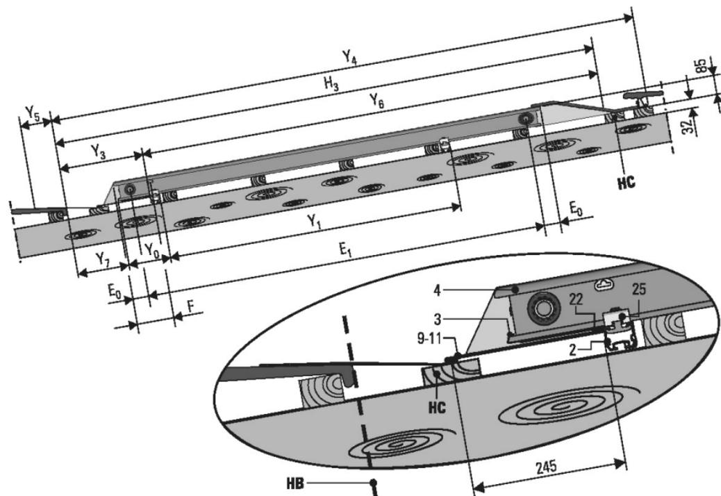
Fig. 1: Vue latérale d'un panneau solaire plat intégré à un toit (illustrée sur un panneau solaire plat EKS-V26P dans un système à vidange autonome)
