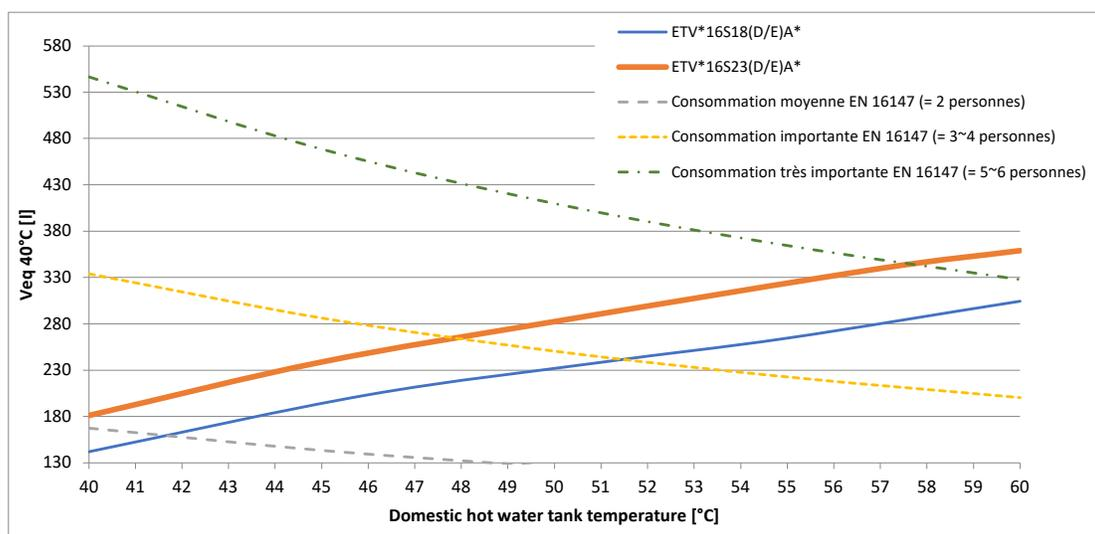
Si une valeur Ve<sub>q</sub> 40°C quotidienne supérieure est requise, des cycles de chauffage supplémentaires sont nécessaires dans les 24 heures.
