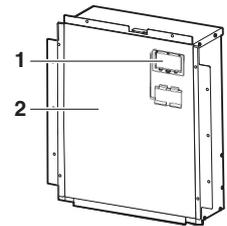
Veiller à remettre le couvercle d'inspection (1) dans le couvercle du coffret électrique (2) une fois que le travail est terminé.
