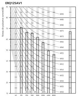
3TW27647-3 Fréquence centrale de la bande d'octave (Hz)
