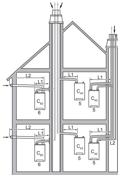
Le système de ventouse horizontale DOIT être installé sous une pente de 3° vers la chaudière (50 mm par mètre) et DOIT être soutenu par au moins 1 attache tous les mètres. Le meilleur emplacement pour fixer l'attache se situe sous le raccord.
