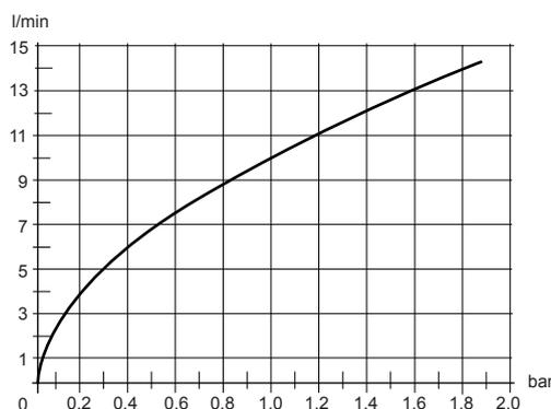
Le débit minimum de fonctionnement de l'eau chaude sanitaire est de 1,5 l/min. La pression minimum est de 0,1 bar. Un faible débit (<5 l/min) peut réduire le confort. Veuillez à ce que le réglage du point de consigne soit suffisamment élevé.
