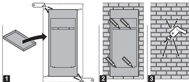
2 Fixez le support mural au mur avec 2 boulons M8.
