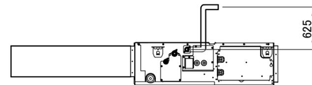
Hauteur du tuyau de sortie de la pompe d'évacuation
