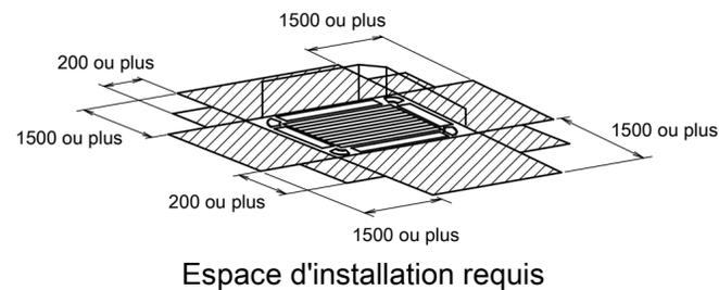
Si une sortie d'évacuation est fermée au moyen du kit en option "élément d'étanchéité", alors l'espace d'installation requis sur ce côté (fermé) est de 500mm au lieu de 1500mm.
