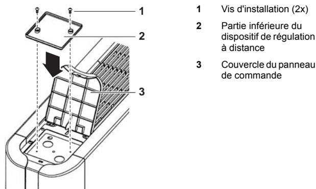
Ouvrir le couvercle du côté gauche du panneau de commande et monter la partie inférieure du dispositif de régulation à distance.
