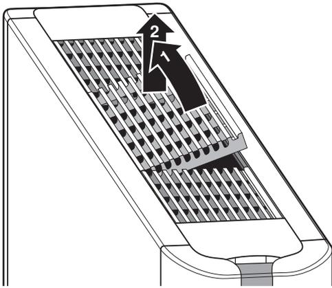
Lever l'arrière à l'aide de l'avant comme levier. Pour l'installer, utiliser la méthode opposée.
