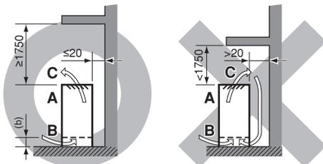
(b)  $\geq 100$  mm en cas de montage au mur
