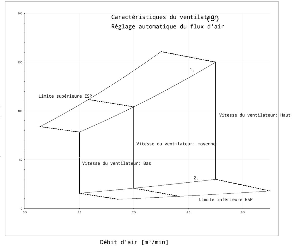
1. Limite supérieure ESP en cas de réglage automatique du flux d'air
