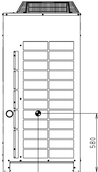
Centre du perçage pour boulon de scellement
