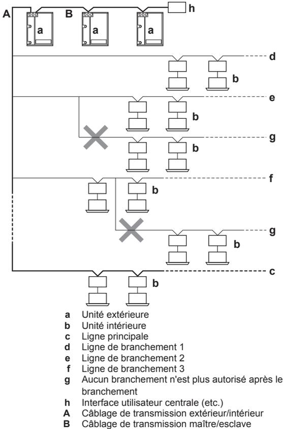
Pour le câblage ci-dessus, utiliser toujours des câbles en vinyle avec une gaine de 0,75 mm<sup>2</sup> à 1,25 mm<sup>2</sup> ou des câbles (2 fils). Les câbles à 3 fils sont permis uniquement pour l'interface utilisateur de changement refroidissement/chauffage.
