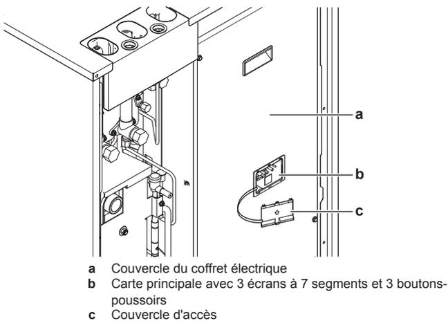
Actionnez les commutateurs et boutons avec une tige isolée (comme un bic) pour éviter de toucher des pièces sous tension.
