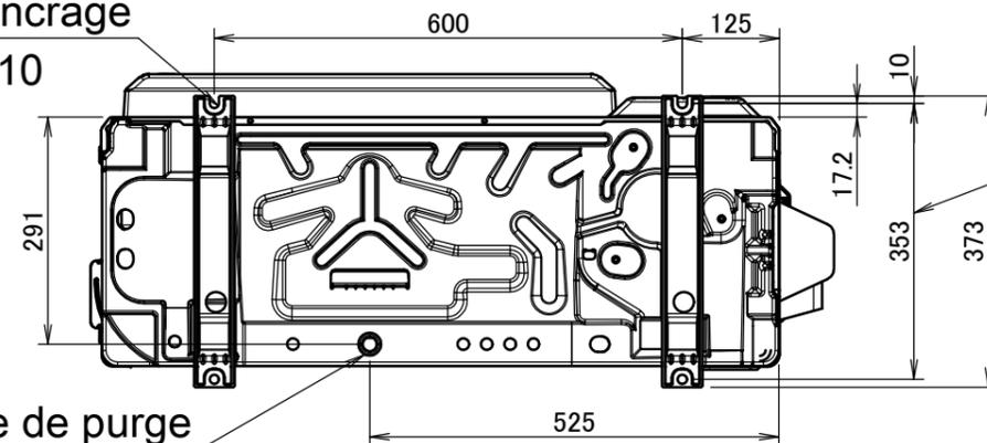
Espacement entre les trous des boulons de fondation
