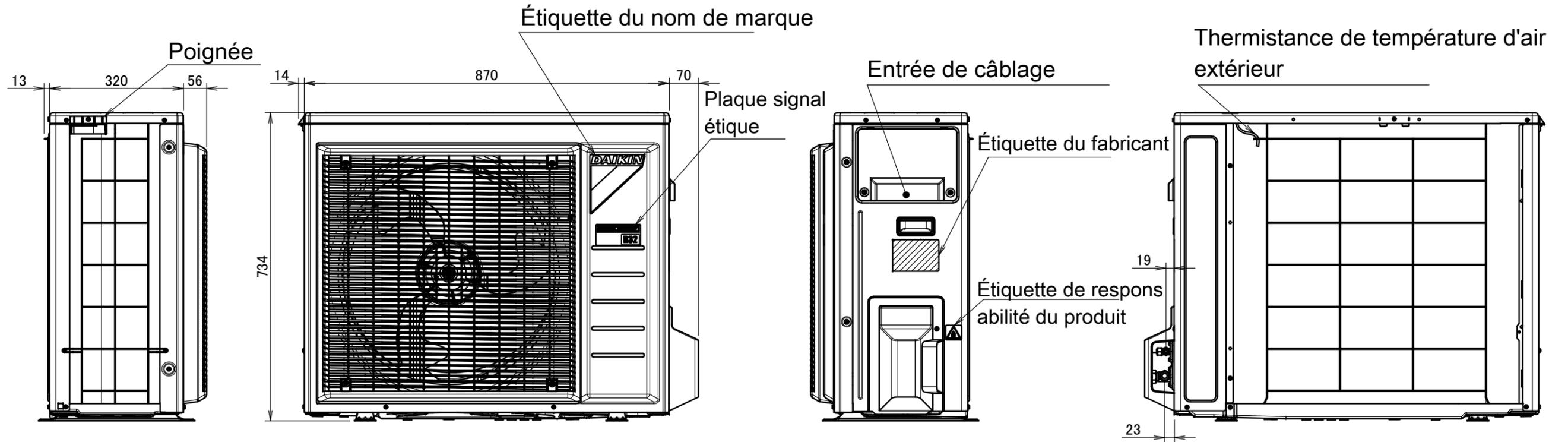
4 trous pour les boulons d'ancrage
