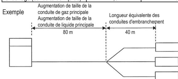
Dans le cas ci-dessus (pour RXYQ38-44) (Réfrigération) Longueur équivalente globale = 80 m x 1,0 + 40 m = 120 m
