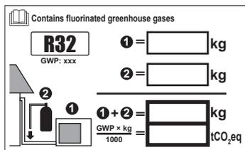
Charge totale=charge d'usine ①+charge supplémentaire ②=3,4 kg +R<sup>(a)</sup>
