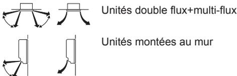
Dans les conditions suivantes, un microprocesseur commande la direction d'écoulement de l'air, qui peut être différente de celle affichée.
