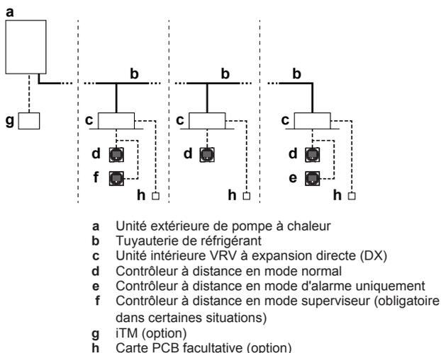
Pour l'installation du contrôleur à distance, veuillez vous reporter au manuel d'installation et d'utilisation livré avec le contrôleur à distance. Chaque unité intérieure doit être connectée à un contrôleur à distance compatible avec le système de sécurité R32 (par ex. BRC1H52/82\* ou type plus récent). Ces contrôleurs à distance ont mis en place des mesures de sécurité qui avertissent l'utilisateur par un signal visuel et sonore en cas de fuite.
