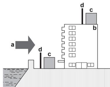
Les vents forts ( $\geq 18$  km/h) qui soufflent contre la sortie d'air de l'unité extérieure peut entraîner un court-circuit (aspiration de l'air évacué). Les conséquences peuvent être les suivantes:
