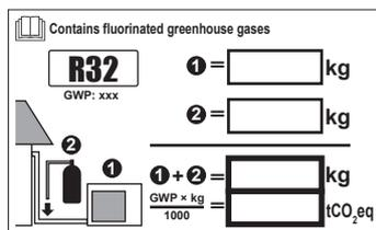
Charge totale=charge d'usine ①+charge supplémentaire ②=3,4 kg+R<sup>(a)</sup>
