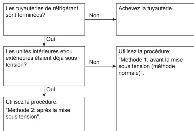
Il est très important que toute la tuyauterie de réfrigérant soit réalisée avant que les unités (extérieure ou intérieure) soient mises en service. Lorsque les unités seront mises sous tension, les vannes d'expansion s'activeront. Cela veut dire que les vannes se fermeront.
