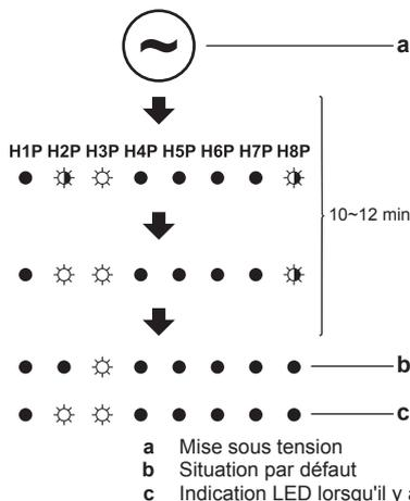
Si la situation par défaut ne s'affiche pas au bout de 10-12 minutes, vérifiez le code d'anomalie affiché sur l'interface utilisateur de l'unité intérieure. Résolez le code de dysfonctionnement en conséquence. Vérifiez d'abord le câble de communication.
