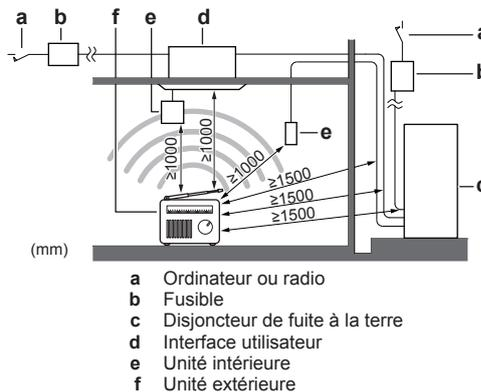
Aux endroits où la réception est faible, maintenir une distance de 3 m ou plus pour éviter des perturbations électromagnétiques et utiliser des gaines pour les lignes électriques et de transmission.
