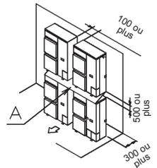
**5. Plusieurs rangées d'installation en série (sur le toit, etc.)**
