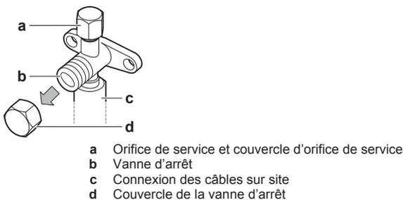
a Orifice de service et couvercle d'orifice de service
