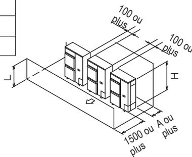
**5. Plusieurs rangées d'installation en série (sur le toit, etc.)**
