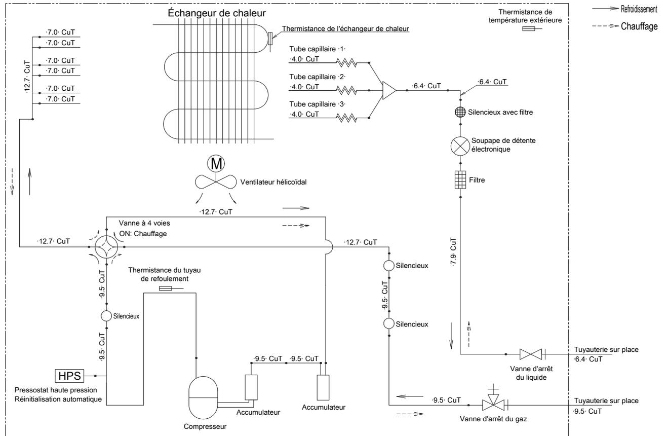
Catégories d'équipement PED – Interrupteur haute pression: catégorie IV; Compresseur: catégorie II; Autre équipement: art. 4§3.
