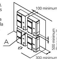
**(E) Plusieurs rangées d'installation série (sur le toit, etc.)**
