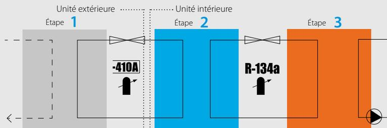
**1** L'unité extérieure extrait l'énergie thermique présente dans l'air extérieur. Cette chaleur est transmise à l'unité intérieure via le réfrigérant R-410A.
