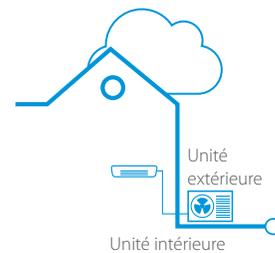
**Configuration split :** un système par pièce, avec une unité intérieure raccordée à une unité extérieure.
