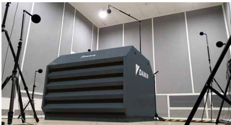
Mesure de niveau de puissance sonore réalisée en chambre acoustique
