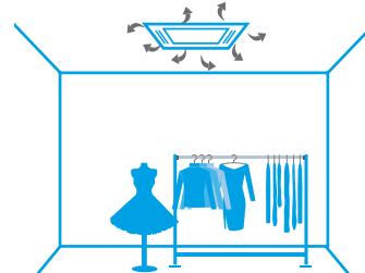
Distribution de l'air avec un filtre poussiéreux
