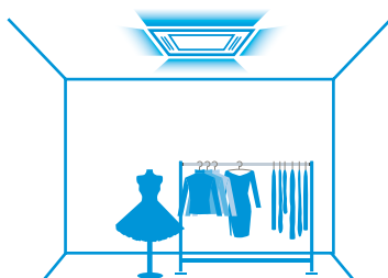
Distribution de l'air avec un filtre propre
