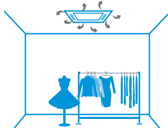
Distribution de l'air avec un filtre poussiéreux
