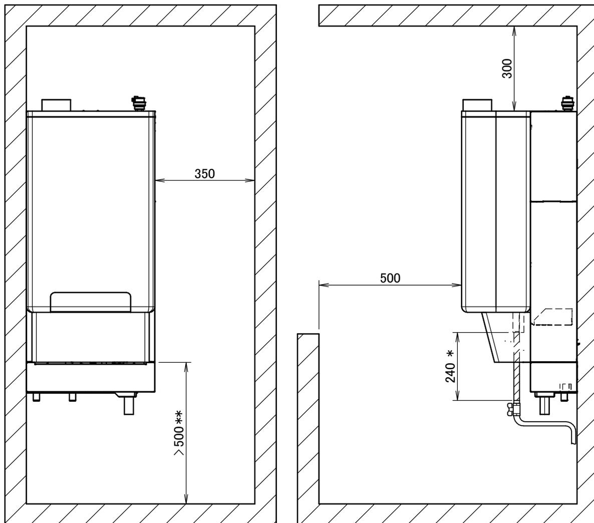
\* Fournissez une tuyauterie démontable pour garantir un bon entretien et une bonne installation du kit de bac de récupération.
