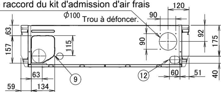
Position du trou à défoncer pour l'admission de la tuyauterie (arrière)
