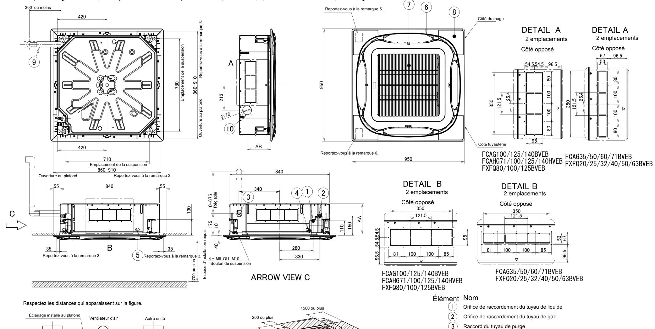
Si une sortie d'évacuation est fermée au moyen du kit en option "élément d'étanchéité", alors l'espace d'installation requis sur ce côté (fermé) est de 500mm au lieu de 1500mm.
