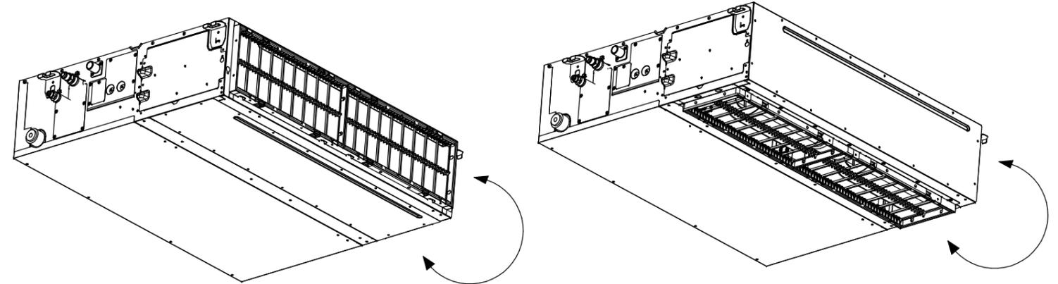
Modification simple de l'aspiration par l'arrière vers l'aspiration par le bas
