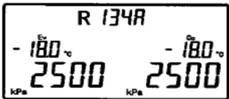
si les sondes de température sont connectées à l'instrument, l'écran LCD affichera la température en temps réel dans le capteur T1 « T1 sensor » et le capteur T2 « T2 sensor », comme indiqué ci-dessous.
