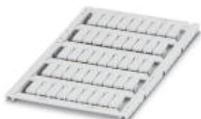
Manchon de repérage pour conducteur, Planche, blanc, vierge, repérable avec : THERMOMARK PRIME, THERMOMARK CARD, BLUEMARK CLED, BLUEMARK LED, LASER TOPMARK, Type de montage: enfilage, pour bloc de jonction au pas de : 5,2 mm, Diamètre du câble: 2,5-4,7 mm, Surface utile: 12 x 5,5 mm
