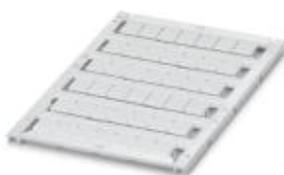
Repères pour blocs de jonction, Plaque, blanc, vierge, repérable avec : THERMOMARK PRIME, THERMOMARK CARD, BLUEMARK CLED, BLUEMARK LED, LASER TOPMARK, Type de montage: Encliquetage dans la rainure de repérage élevée, pour bloc de jonction au pas de : 8,2 mm, Surface utile: 7,6 x 10,5 mm
