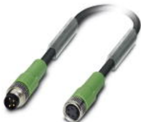
Câbles pour capteurs/actionneurs, 4-pôles, PVC, noir RAL 9005, Connecteur droite M8, sur Connecteur femelle droite M8, Longueur du câble: 0,3 m
