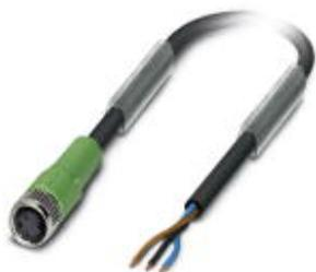
Câbles pour capteurs/actionneurs, 3-pôles, PVC, noir RAL 9005, extrémité libre, sur Connecteur femelle droite M8, Longueur du câble: 1,5 m
