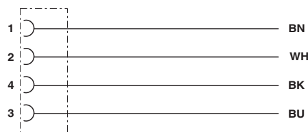
Disposition des contacts des connecteurs M12 mâles et femelles
