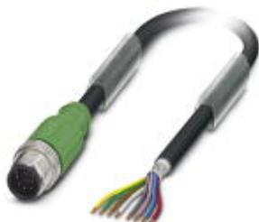
Câbles pour capteurs/actionneurs, 8-pôles, PUR exempt d'halogène, gris-noir RAL 7021, blindé, Connecteur droite M12, détrompage A, sur extrémité libre, Longueur du câble: 10 m
