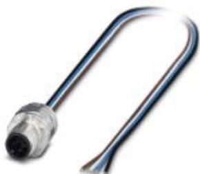
Connecteur mâle encastrable pour capteurs/actionneurs, 4 pôles, M12 SPEEDCONNEC, détrompage A, montage vissé/sur face avant avec filetage M16, positionnable, avec cordon TPE de 0,5 m, 4 x 0,34 mm<sup>2</sup>
