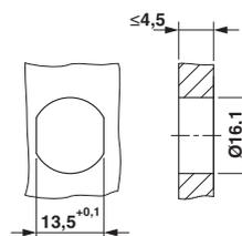
Découpe du boîtier pour filet de fixation M16, paroi de montage avec perçage traversant (alternativement avec surface de protection anti-torsion)
