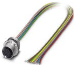
Connecteurs encastrables, Universel, 8-pôles, Connecteur femelle, droite, M12-SPEEDCON, détrompage A, Montage sur face avant, M16 x 1,5, Cordons individuels, Longueur du câble: 0,5 m
