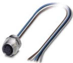
Connecteur femelle encastrable pour capteurs et actionneurs, 5 pôles, M12, détrompage A, montage vissé/ sur face avant, filetage Pg9, avec cordon TPE de 0,5 m, 5x 0,34 mm<sup>2</sup>
