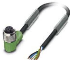
Câbles pour capteurs/actionneurs, 5-pôles, PUR exempt d'halogène, gris-noir RAL 7021, extrémité libre, sur Connecteur femelle coudé M12, détrompage A, Longueur du câble: 10 m
