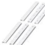
Repérage ZB, plat, à commander : par bandes, blanc, impression selon les indications du client, Type de montage: Encliquetage dans la rainure de repérage plate, pour bloc de jonction au pas de : 12 mm, Surface utile: 5,15 x 12,15 mm
