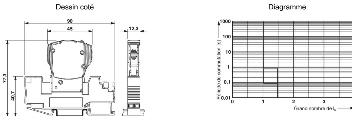
La figure montre le module complet, se compose d'un élément de base et d'un connecteur mâle
