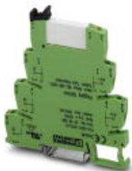
Interface PLC, comprend l'embase PLC-BSC.../21 avec connexion vissée et un relais miniature enfichable à contact de puissance, se monte sur profilé NS 35/7,5, 1 inverseurs, tension d'entrée 230 V AC/220 V DC
