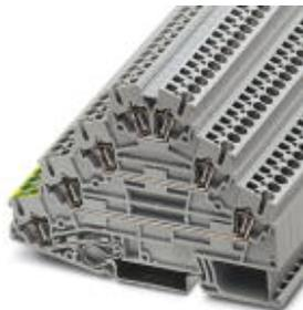
Bloc moteur, quatre étages, avec pied PE, connectique : raccordement à ressort, section : 0,08 mm<sup>2</sup> - 4 mm<sup>2</sup>, AWG : 28 - 12, largeur : 5,2 mm, coloris : gris, type de montage : NS 35/7,5, NS 35/15
