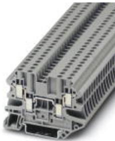
Blocs de jonction simple, type de raccordement: Raccordement vissé, nombre de connexions: 4, section :0,14 mm<sup>2</sup> - 4 mm<sup>2</sup>, AWG: 26 - 12, largeur: 5,2 mm, coloris: gris, type de montage: NS 35/7,5, NS 35/15
